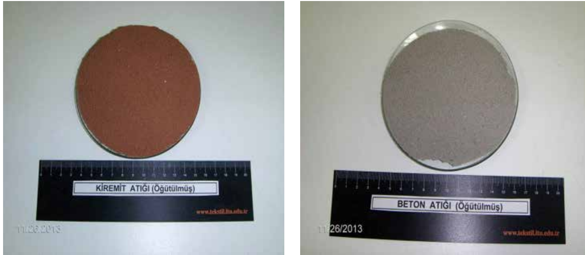
Şekil 1. İYA tesisinden alınan öğütülmüş numunelerin görüntüsü
