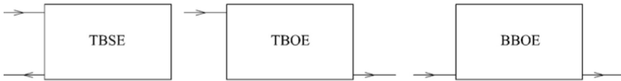
Şekil 4. Radyatör giriş-çıkış bağlantı konumları
